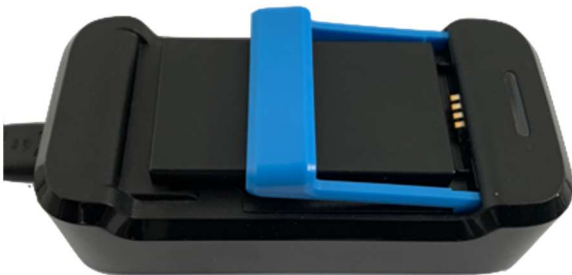
Afbeelding 5: onjuist geplaatste accu
