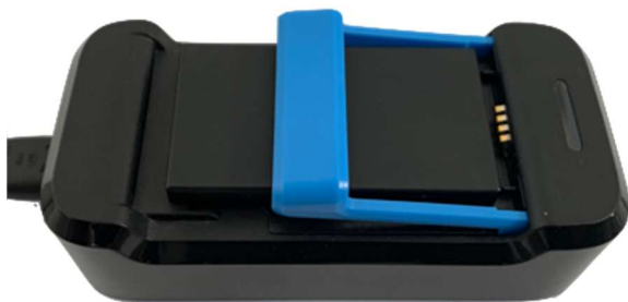
Afbeelding 5: onjuist geplaatste accu
