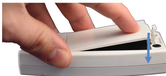
Afbeelding 4: correct sluiten van het klepje
